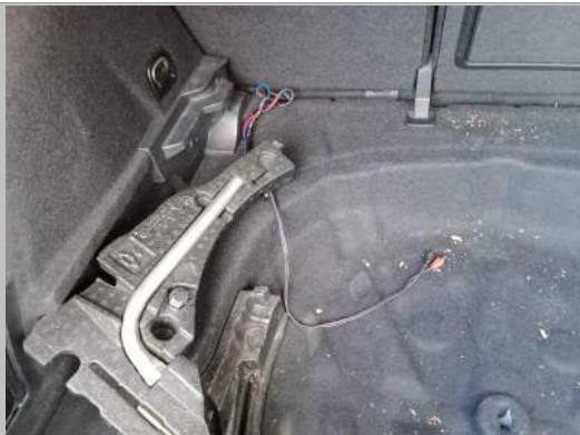
Loose sound wiring
