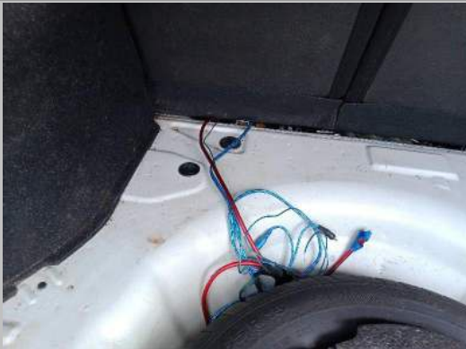
Loose sound wiring
