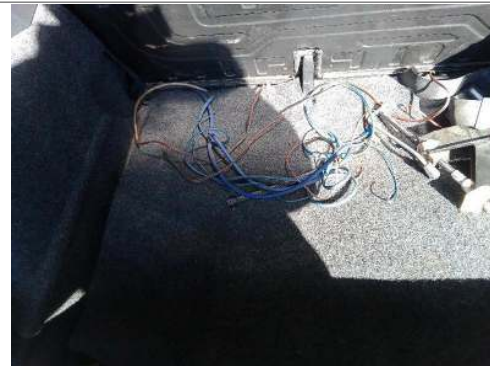
Loose sound wiring
